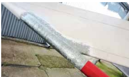
Výškové kormidlo po pretmelení a prebrúsení
