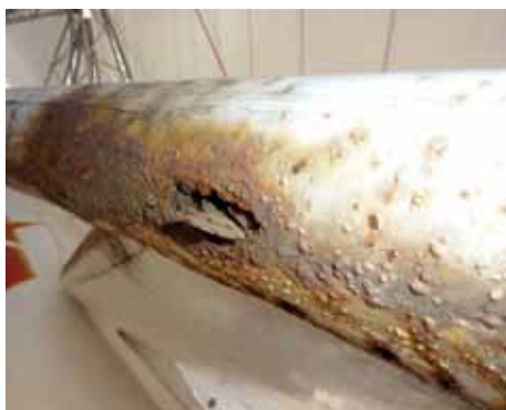
Detail napadnutia výškového kormidla koróziou lietadla Fantan Q-6
