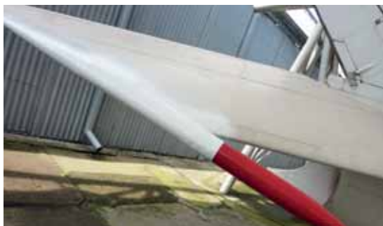
Výškové kormidlo po celkovej úprave
