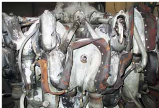
Nálezový stav motora - valcov motora Gnome-Rhone rok 2013
