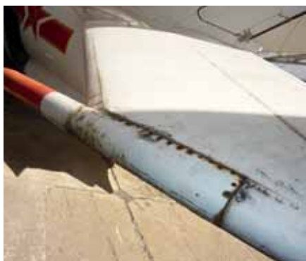
Detail napadnutia výškového kormidla koróziou lietadla Fantan Q-6
