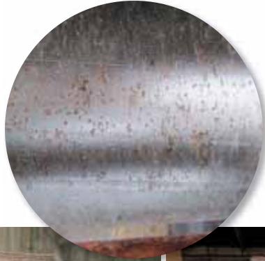
Detail opotrebovaného drážkovania mlecích valcov
